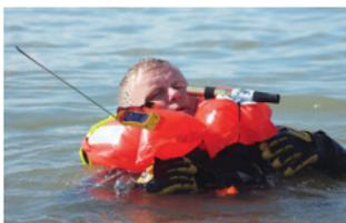
Lorsqu'elle est ajustée à un gilet de sauvetage porté par une personne tombée à l'eau, la PLB3 se positionnera d'elle-même en haut du gilet, l'antenne déployée à la verticale. Repositionnez la PLB3 si elle n'est plus fixée correctement au tube de gonflage.
